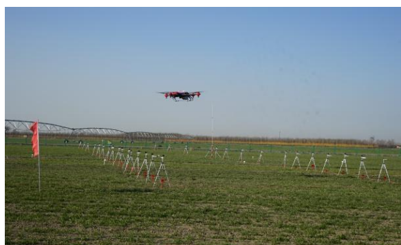
图2 P30植保无人机田间飘移测试场景
