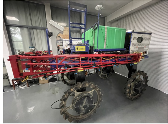
图1 高地隙四轮独立驱动电动喷雾机
